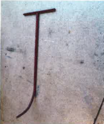
Rebar J Hook
